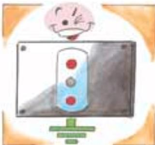
Sempre ai fini della sicurezza è inoltre indispensabile la presenza degli **schermi di protezione**, ovvero coperchietti mobili in materiale plastico che otturano i 2 fori o alveoli delle prese in tensione e non il foro o alveolo di terra. Questi schermi si spostano solo quando entrambi gli spinotti di una spina li premono contemporaneamente.
