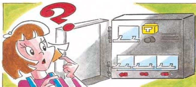
togliere corrente solo in una di queste, si può agire sullo specifico interruttore della parte interessata. Questa operazione si può fare solo se si conosce bene l'esatta configurazione dell'impianto elettrico, altrimenti è consigliabile agire sull'interruttore generale.
