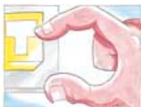
Almeno una volta al mese devi premere il tasto di prova **T** ed accertarti che la leva dell'interruttore scatti automaticamente togliendo corrente all'impianto elettrico. Subito dopo riporta manualmente la leva nella posizione iniziale e verifica che si sia ripristinato il corretto funzionamento dell'impianto. Se ciò non accade può esserci un grave pericolo: chiama l'installatore.
