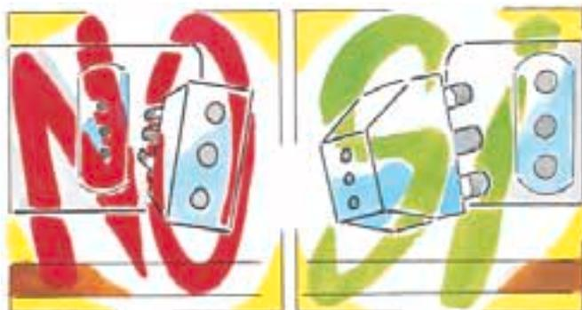
Gli adattatori si possono collegare ad apparecchi utilizzatori **fino ad una potenza massima complessiva di 1500 W e solo per un uso temporaneo.**
